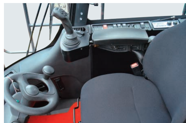
同時操作性の良いジョイスティックFRレバーも一体で装備。
