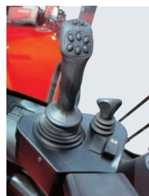
同時操作性の良いジョイスティックFRレバーも一体で装備。
